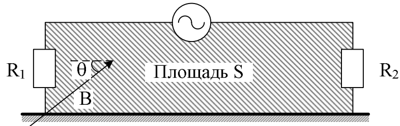
Рис. 4.8. Магнитное поле с плотностью потока B пересекает площадь S под углом \theta .
